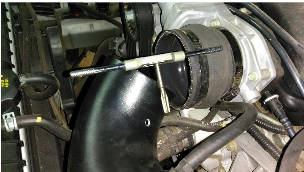
Tanto para o fogger seco quando para o molhado a rosca para o fogger é NPT 1/16" (rosca cônica). É uma rosca padrão, comercializada regulamente, porém não muito comum. Se tiver dificuldades em encontrar esse macho entre em contato conosco.
