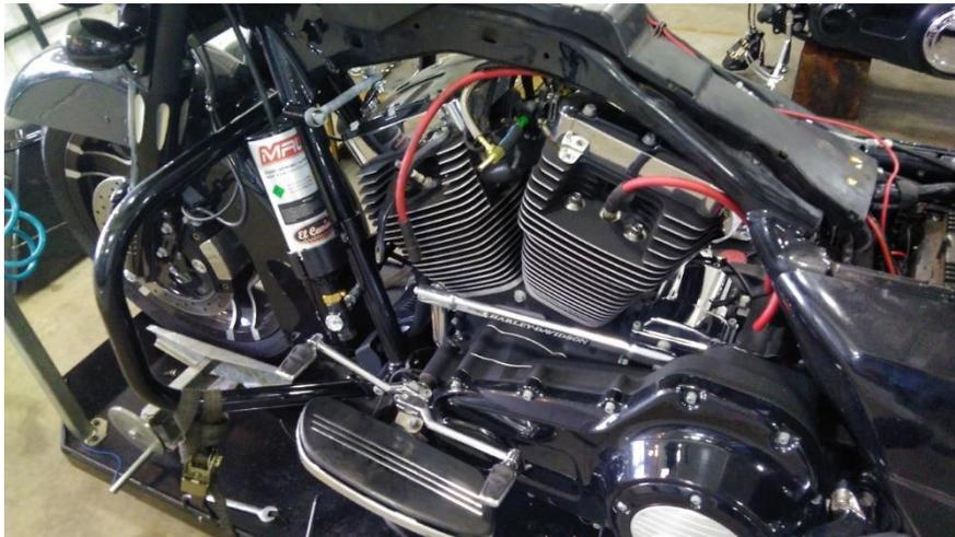
Conecte a mangueira de nitro, um lado no cilindro, outro lado na entrada do solenoide de nitro.
